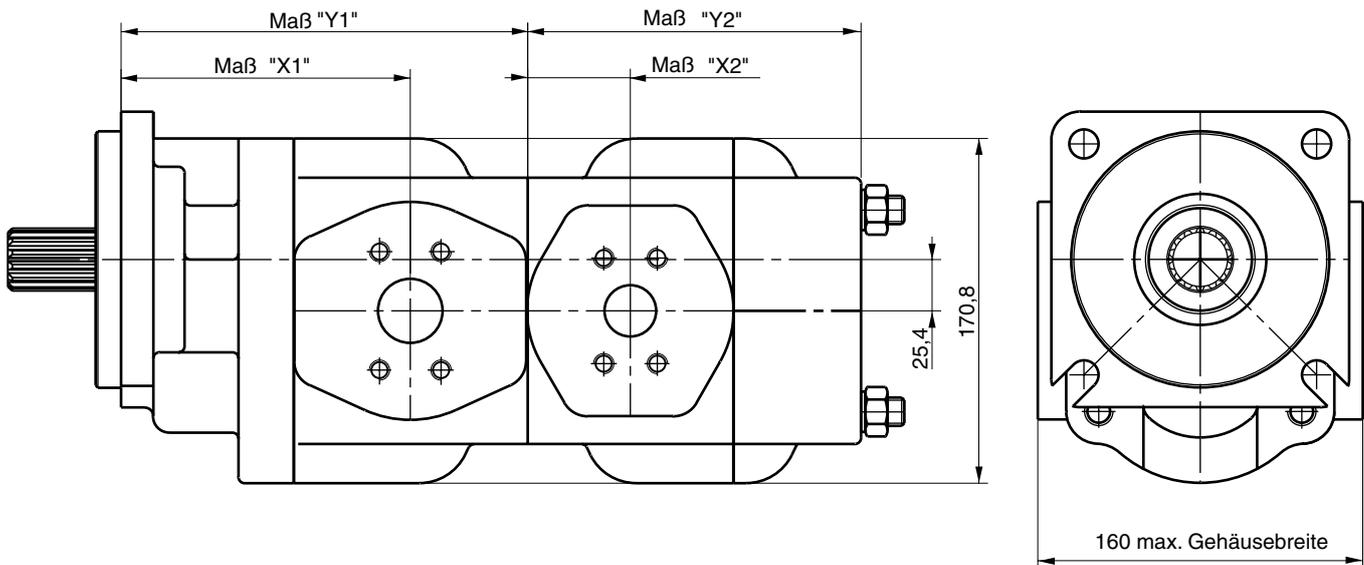
**PGP 640/620 Spezifikation - Standardverdrängungsvolumen- Mehrfachgerät**
