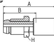
**WERKSTOFF** Nippel: Stahl, verzinkt, transparent Cr(VI)-frei passiviert.
