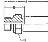
**WERKSTOFF** Stahl, verzinkt, transparent Cr(VI)-frei passiviert.
