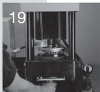
Schlauch und Armatur von unten durch die Pressbacken einschieben. Armatur so positionieren, dass der untere Rand ihrer Hülse auf dem Anschlag der Pressbacken sitzt.
