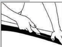
Mehrfachschlauchleitung fest und flach auf die Arbeitsfläche drücken, damit sie sich nicht bewegen kann. Messer mit gleichmäßig leichtem bis mittelstarkem Druck führen. Diesen Vorgang so oft wiederholen, bis die Schläuche getrennt sind.
