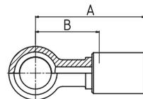
**WERKSTOFF** Nippel: Stahl, verzinkt, transparent Cr(VI)-frei passiviert.
