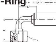
**WERKSTOFF** Stahl, verzinkt, transparent Cr(VI)-frei passiviert.
