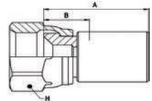
**WERKSTOFF** Nippel: Stahl, verzinkt, transparent Cr(VI)-frei passiviert.
