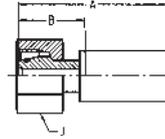
**WERKSTOFF** Stahl, verzinkt, transparent Cr(VI)-frei passiviert.
