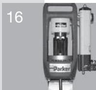
Schlauch mit Armatur von unten in die Pressbacken einschieben.
