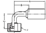
**WERKSTOFF** Stahl, verzinkt, transparent Cr(VI)-frei passiviert.
