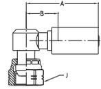
**WERKSTOFF** Stahl, verzinkt, transparent Cr(VI)-frei passiviert.
