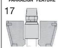
Armatur so ausrichten, dass die Hülse auf dem Anschlag des Presswerkzeugs aufliegt.
