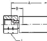
**WERKSTOFF** Stahl, verzinkt, transparent Cr(VI)-frei passiviert.
