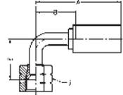
**WERKSTOFF** Stahl, verzinkt, transparent Cr(VI)-frei passiviert.
