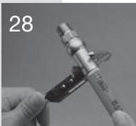
Pressdurchmesser an jeder Armatur oben, in der Mitte und unten an der Hülse nachmessen. An mindestens drei Stellen des Umfangs der Hülse messen. Prüfen, ob das Pressmaß innerhalb der Toleranzen liegt. (Für das korrekte Pressmaß siehe Tabelle Pressmaße und Werkzeugauswahl in diesem Kapitel des Katalogs).
