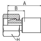
**WERKSTOFF** Nippel: Stahl, verzinkt, transparent Cr(VI)-frei passiviert.
