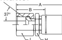
**WERKSTOFF** Stahl, verzinkt, transparent Cr(VI)-frei passiviert.
