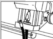
Die aufgetrennte Länge muss lang genug sein, damit beim Verpressen der Armaturen ein Abknicken der Schläuche vermieden wird.
