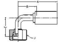
**WERKSTOFF** Stahl, verzinkt, transparent Cr(VI)-frei passiviert.
