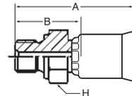
**WERKSTOFF** Stahl, verzinkt, transparent Cr(VI)-frei passiviert.
