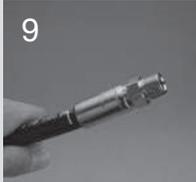
Schlauch bis zur Markierung der Einschubtiefe in die Armatur einschieben.
