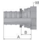
**WERKSTOFF** Stahl, verzinkt, transparent Cr(VI)-frei passiviert.
