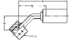
**WERKSTOFF** Stahl, verzinkt, transparent Cr(VI)-frei passiviert.
