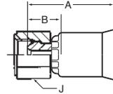
**WERKSTOFF** Stahl, verzinkt, transparent Cr(VI)-frei passiviert.
