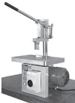
Das **polyflex**-Schlauchtrenngerät ST250 ist zum Trennen von Thermoplastschläuchen mit Druckträger aus Textilfasern oder Draht (bis 6 Lagen) bis DN 25 verwendbar. Das Trenngerät ist für Kleinserien, Einzelschläuche und Reparaturen geeignet.
