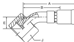
**WERKSTOFF** Stahl, verzinkt, transparent Cr(VI)-frei passiviert.
