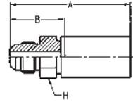
**WERKSTOFF** Stahl, verzinkt, transparent Cr(VI)-frei passiviert.
