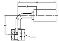
**WERKSTOFF** Stahl, verzinkt, transparent Cr(VI)-frei passiviert.
