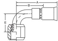
**WERKSTOFF** Stahl, verzinkt, transparent Cr(VI)-frei passiviert.
