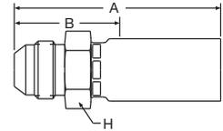
**WERKSTOFF** Stahl, verzinkt, transparent Cr(VI)-frei passiviert.
