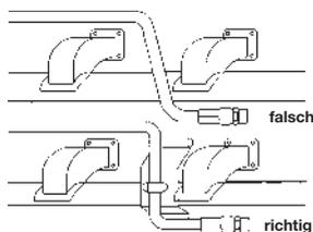
Der Einbau von Schlauchleitungen in der Nähe von Wärmequellen ist zu vermeiden. Sollte dies jedoch erforderlich sein, ist der Schlauch entsprechend zu isolieren.
