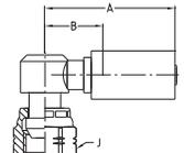
**WERKSTOFF** Stahl, verzinkt, transparent Cr(VI)-frei passiviert.
