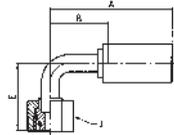
**WERKSTOFF** Stahl, verzinkt, transparent Cr(VI)-frei passiviert.
