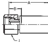
**WERKSTOFF** Stahl, verzinkt, transparent Cr(VI)-frei passiviert.
