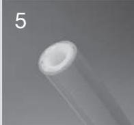
5 Beide Schlauchenden visuell auf Rechtwinkligkeit überprüfen. Eventuelle Grate an der Innenschicht mit einem scharfen Messer entfernen.
