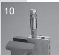
Armatur wie folgt durch Aufklopfen auf dem Schlauch anbringen: Parker VBS- oder VBL-Schraubstockbacken verwenden und Schlauch mit Armatur dort in die richtige Öffnung einführen. Dann Backen mit Schlauch und Armatur in einen auf einer Werkbank befestigten Schraubstock einsetzen.
