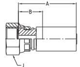
**WERKSTOFF** Stahl, verzinkt, transparent Cr(VI)-frei passiviert.
