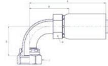
**WERKSTOFF** Stahl, verzinkt, transparent Cr(VI)-frei passiviert.
