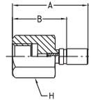
**WERKSTOFF** Stahl, verzinkt, transparent Cr(VI)-frei passiviert.
