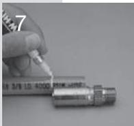
7 Schlauchende mit der richtigen Einschubtiefe markieren. (Einschubtiefe = Abmessung "A" minus "B" gemäß den Armaturentabellen in Kapitel B bis E)
