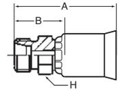
**WERKSTOFF** Stahl, verzinkt, transparent Cr(VI)-frei passiviert.
