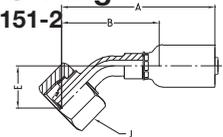
**WERKSTOFF** Stahl, verzinkt, transparent Cr(VI)-frei passiviert.
