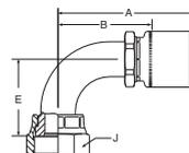
**WERKSTOFF** Stahl, verzinkt, transparent Cr(VI)-frei passiviert.
