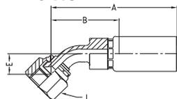
**WERKSTOFF** Stahl, verzinkt, transparent Cr(VI)-frei passiviert.
