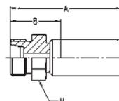
**WERKSTOFF** Stahl, verzinkt, transparent Cr(VI)-frei passiviert.
