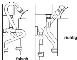
Wo nötig, sind Bogenarmaturen oder Adapter zu verwenden, um übermäßige Schlauchlängen zu vermeiden und um für einen übersichtlicheren Einbau und unkomplizierte Wartung zu sorgen.
