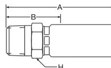
**WERKSTOFF** Stahl, verzinkt, transparent Cr(VI)-frei passiviert.
