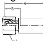
**WERKSTOFF** Stahl, verzinkt, transparent Cr(VI)-frei passiviert.
