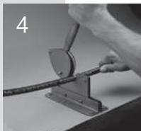
Schlauch mit einem Parflex PHC-Handschneider oder einem anderen scharfen Schneidwerkzeug gerade ab- und auf die richtige Länge zuschneiden.
