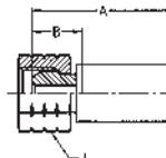
**WERKSTOFF** Stahl, verzinkt, transparent Cr(VI)-frei passiviert.
