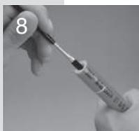
Die Innenseite des Schlauchendes mit einem SAE 20 Schmieröl leicht schmieren.
