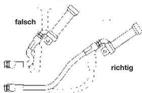
Wenn eine Schlauchleitung in einer Anwendung mit Biegebeanspruchung eingesetzt wird, ist zu beachten, dass die metallischen Schlaucharmaturen nicht zum flexiblen Teil gehören.
