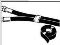
Je nach Installationsanforderung sollten im Endbereich der aufgetrennten Schläuche die losen Schlauchenden mit Nylon- oder Klebeband zusammengehalten werden, um die Außenschicht der Schläuche gegen Aufreißen zu schützen.
