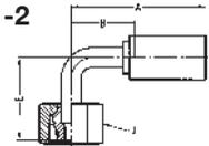
**WERKSTOFF** Stahl, verzinkt, transparent Cr(VI)-frei passiviert.
