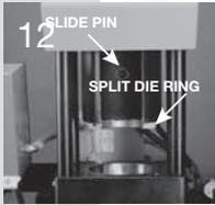
Stempel ganz hochfahren und die hintere Hälfte des geteilten Backenrings in den hinteren Teil des Stempels einlegen. Ring durch Einschieben des Feststellstifts arretieren.
