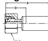
**WERKSTOFF** Stahl, verzinkt, transparent Cr(VI)-frei passiviert.
