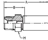
**WERKSTOFF** Stahl, verzinkt, transparent Cr(VI)-frei passiviert.
