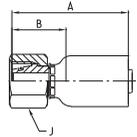
**WERKSTOFF** Stahl, verzinkt, transparent Cr(VI)-frei passiviert.
