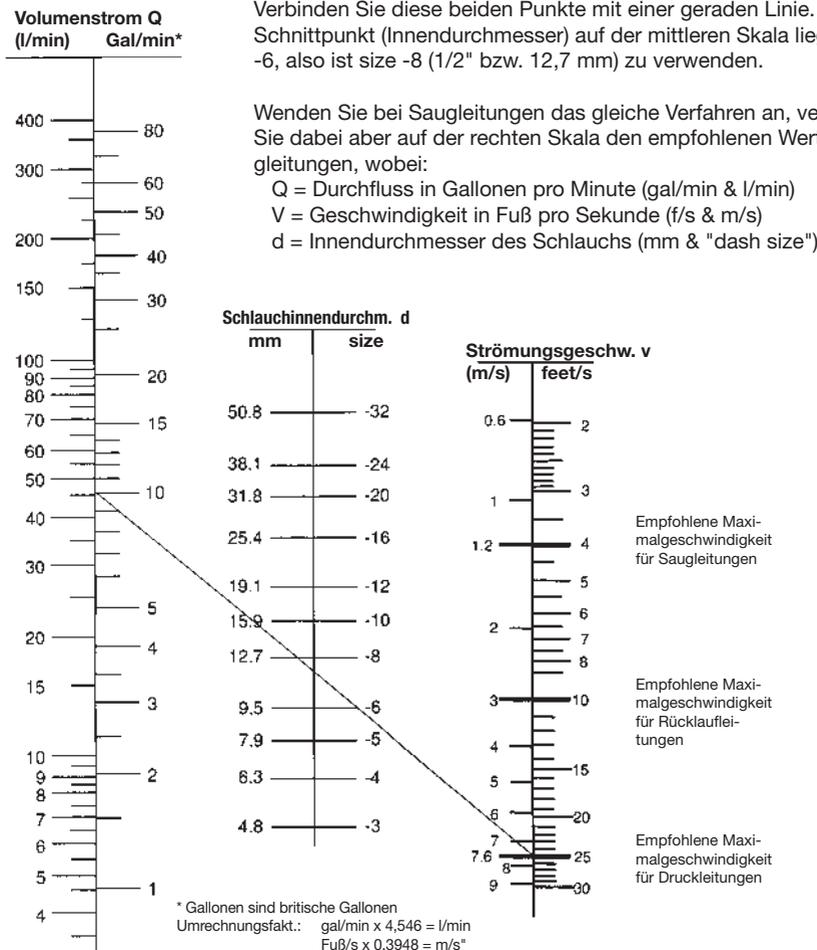
Empfohlene Maximalgeschwindigkeit für Saugleitungen
