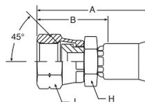
**WERKSTOFF** Stahl, verzinkt, transparent Cr(VI)-frei passiviert.
