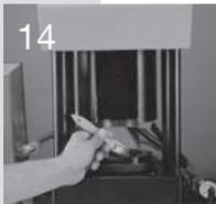
Eine dünne Schicht Schmiermittel auf Molybdän-Disulfid-Basis auf die Innenseite des Adaptereinsatzes auftragen.
