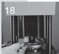
Vordere Hälfte des geteilten Backenrings einlegen und den Stift in der hinteren Hälfte mit dem Loch in der vorderen Hälfte ausrichten.
