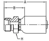
**WERKSTOFF** Stahl, verzinkt, transparent Cr(VI)-frei passiviert.
