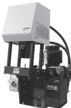
Für Parker-Schläuche mit Druckträger aus Textil- und Stahlgeflech-ten sowie Wickellagen aus Stahldraht bis zu DN 32. Mit Hydraulik-pumpe und Grundrahmen, jedoch ohne Pressbacken.
