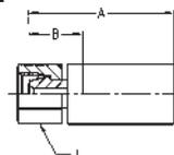
**WERKSTOFF** Stahl, verzinkt, transparent Cr(VI)-frei passiviert.
