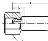
**WERKSTOFF** Stahl, verzinkt, transparent Cr(VI)-frei passiviert.
