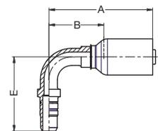
**WERKSTOFF** Stahl, verzinkt, transparent Cr(VI)-frei passiviert.
