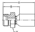
**WERKSTOFF** Stahl, verzinkt, transparent Cr(VI)-frei passiviert.
