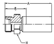
**WERKSTOFF** Stahl, verzinkt, transparent Cr(VI)-frei passiviert.
