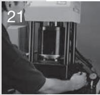
Schlauch und Armatur am Pressbackenanschlag in Position halten und Stempel durch Ziehen des Ventilhebels nach vorne absenken.
