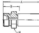
**WERKSTOFF** Stahl, verzinkt, transparent Cr(VI)-frei passiviert.
