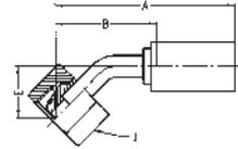
**WERKSTOFF** Stahl, verzinkt, transparent Cr(VI)-frei passiviert.
