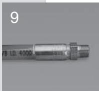
Schlauch bis zur Markierung der Einschubtiefe in die Armatur einschieben.
