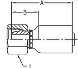
**WERKSTOFF** Stahl, verzinkt, transparent Cr(VI)-frei passiviert.
