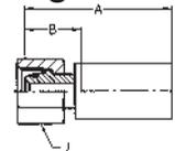
**WERKSTOFF** Stahl, verzinkt, transparent Cr(VI)-frei passiviert.
