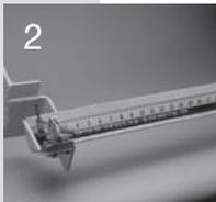
Schlauch in einer geeigneten Halterung fixieren, um ihn gestreckt zu halten.
