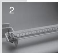
Schlauch in einer geeigneten Halterung fixieren, um ihn gestreckt zu halten.
