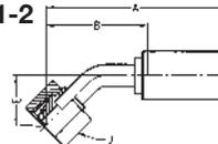
**WERKSTOFF** Stahl, verzinkt, transparent Cr(VI)-frei passiviert.
