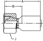
**WERKSTOFF** Stahl, verzinkt, transparent Cr(VI)-frei passiviert.
