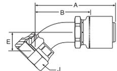
**WERKSTOFF** Stahl, verzinkt, transparent Cr(VI)-frei passiviert.
