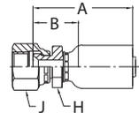
**WERKSTOFF** Stahl, verzinkt, transparent Cr(VI)-frei passiviert.
