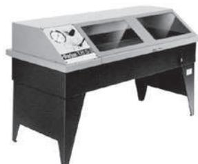
Der Werkstatt-Prüfstand eignet sich für die statische Druckprüfung von einbaufertigen Schlauchleitungen mit einem Prüfdruck von 12 bis zu 145 MPa. Es können fast alle marktüblichen Standardarmaturen angeschlossen werden.
