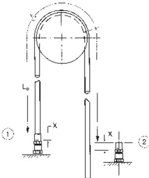
1. Schlauch mit einer Kupplung montieren, wie in der Zeichnung dargestellt.
