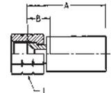
**WERKSTOFF** Stahl, verzinkt, transparent Cr(VI)-frei passiviert.
