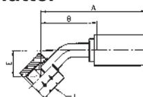
**WERKSTOFF** Stahl, verzinkt, transparent Cr(VI)-frei passiviert.
