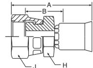
**WERKSTOFF** Stahl, verzinkt, transparent Cr(VI)-frei passiviert.
