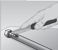
Schlauch mit einem Messer leicht schräg zur Längsachse (in einem Winkel von etwa 20°) aufschneiden. Darauf achten, dass die Rippen der Armatur nicht beschädigt werden.
