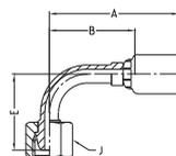
**WERKSTOFF** Stahl, verzinkt, transparent Cr(VI)-frei passiviert.
