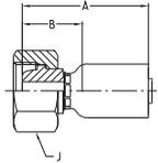
**WERKSTOFF** Stahl, verzinkt, transparent Cr(VI)-frei passiviert.
