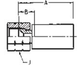
**WERKSTOFF** Stahl, verzinkt, transparent Cr(VI)-frei passiviert.
