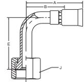
**WERKSTOFF** Stahl, verzinkt, transparent Cr(VI)-frei passiviert.
