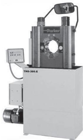
Durch den Einsatz modernster, innovativer Gleitlager ist dieses Gerät die perfekte Ergänzung des bestehenden Maschinenprogramms von Parker (Parkrimp®-System und Polykrimp-Geräte). Die TH8-380.E ist eine Hochleistungs-Schlauchpresse zur Verpressung von sämtlichen Parker-Schlauchtypen mit einem Druckträger von 4 oder 6 Wickellagen aus Stahldraht.
