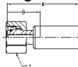
**WERKSTOFF** Stahl, verzinkt, transparent Cr(VI)-frei passiviert.
