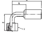
**WERKSTOFF** Stahl, verzinkt, transparent Cr(VI)-frei passiviert.
