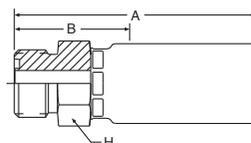
**WERKSTOFF** Stahl, verzinkt, transparent Cr(VI)-frei passiviert.
