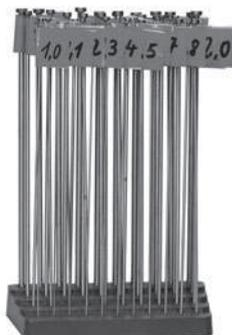
Der Prüfdorn-Satz besteht aus 41 Einzeldornen von 1,0 - 5,0 mm. Die Sprunggrößen sind jeweils 0,1 mm.
