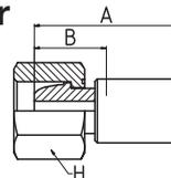
**WERKSTOFF** Nippel: Stahl, verzinkt, transparent Cr(VI)-frei passiviert.
