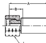
**WERKSTOFF** Stahl, verzinkt, transparent Cr(VI)-frei passiviert.
