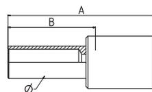
**WERKSTOFF** Nippel: Stahl, verzinkt, transparent Cr(VI)-frei passiviert.
