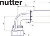
**WERKSTOFF** Stahl, verzinkt, transparent Cr(VI)-frei passiviert.
