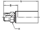
**WERKSTOFF** Stahl, verzinkt, transparent Cr(VI)-frei passiviert.
