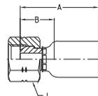
**WERKSTOFF** Stahl, verzinkt, transparent Cr(VI)-frei passiviert.
