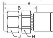
**WERKSTOFF** Nippel, Überwurfmutter und Klemmringe aus Edelstahl (AISI 316),
