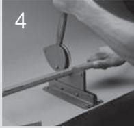
4 Schlauch mit einem Parflex PHC-Handsneider oder einem anderen scharfen Schneidwerkzeug gerade ab- und auf die richtige Länge zuschneiden.
