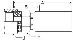
**WERKSTOFF** Stahl, verzinkt, transparent Cr(VI)-frei passiviert.
