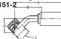
**WERKSTOFF** Stahl, verzinkt, transparent Cr(VI)-frei passiviert.
