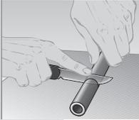
Schlauch senkrecht mit einem scharfen Messer abschneiden. Falls erforderlich, Armaturende mit Wasser oder Wasser-Seifenlösung (5% Flüssigseife + 95% Wasser) zur leichteren Montage benetzen.
