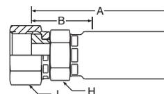
**WERKSTOFF** Stahl, verzinkt, transparent Cr(VI)-frei passiviert.
