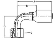
**WERKSTOFF** Stahl, verzinkt, transparent Cr(VI)-frei passiviert.
