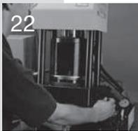
Armatur so lange mit dem Schlauch verpressen, bis der Backenring auf der Grundplatte aufliegt.
