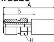
**WERKSTOFF** Nippel: Stahl, verzinkt, transparent Cr(VI)-frei passiviert.
