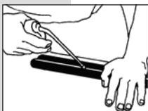
Den Bereich zwischen den zu trennenden Schläuchen leicht mit Öl schmieren. Das Öl dient dazu die Reibung der Messerklinge zu reduzieren.
