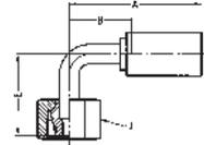
**WERKSTOFF** Stahl, verzinkt, transparent Cr(VI)-frei passiviert.
