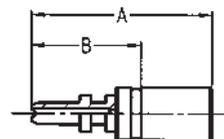
**WERKSTOFF** Stahl, verzinkt, transparent Cr(VI)-frei passiviert.
