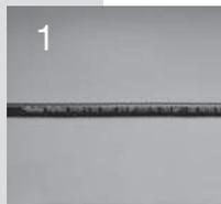
Überprüfen, ob die Angaben zu Typ und Nennweite auf der Schlauchmarkierung mit dem Arbeitsauftrag übereinstimmen.
