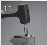
Mit einem Gummihammer die Armatur so lange leicht auf den Schlauch aufklopfen, bis der untere Rand der Hülse mit der Markierung der Einschubtiefe übereinstimmt.
