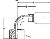
**WERKSTOFF** Stahl, verzinkt, transparent Cr(VI)-frei passiviert.
