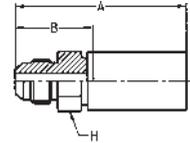
**WERKSTOFF** Stahl, verzinkt, transparent Cr(VI)-frei passiviert.
