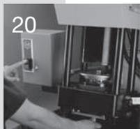
Zum Einschalten der Pumpe entsprechenden Schalter betätigen.
