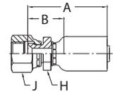
**WERKSTOFF** Stahl, verzinkt, transparent Cr(VI)-frei passiviert.
