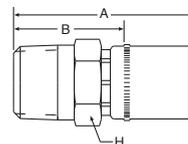
**WERKSTOFF** Stahl, verzinkt, transparent Cr(VI)-frei passiviert.
