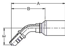
**WERKSTOFF** Stahl, verzinkt, transparent Cr(VI)-frei passiviert.
