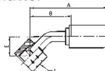
**WERKSTOFF** Stahl, verzinkt, transparent Cr(VI)-frei passiviert.
