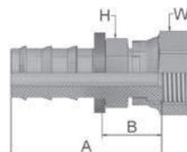
**WERKSTOFF** Stahl, verzinkt, transparent Cr(VI)-frei passiviert.
