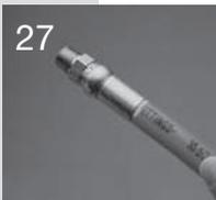
Markierung der Einschubtiefe an den Armaturen überprüfen. Die Markierung muss sichtbar sein und darf maximal 3 mm vom unteren Rand der Armaturenhülse entfernt sein.
