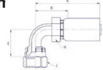
**WERKSTOFF** Stahl, verzinkt, transparent Cr(VI)-frei passiviert.
