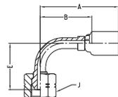
**WERKSTOFF** Stahl, verzinkt, transparent Cr(VI)-frei passiviert.
