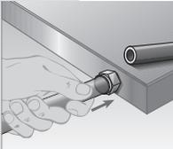
Armatur in den Schlauch stecken und so lange mit gleichmäßiger Kraft einschieben, bis sich die Armatur komplett im Schlauch befindet. Dabei ist der Schlauch etwa 2,5 cm von der Schnittstelle entfernt zu halten. Alternativ kann das Parker Montagewerkzeug 611050G verwendet werden.
