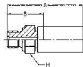
**WERKSTOFF** Stahl, verzinkt, transparent Cr(VI)-frei passiviert.
