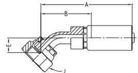
**WERKSTOFF** Stahl, verzinkt, transparent Cr(VI)-frei passiviert.
