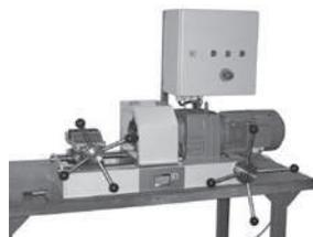
Die **polyflex**-Schlauchmontagemaschine SMM100 ist für die Montage von Höchstdruck-Schlauchleitungen geeignet. Zu der Standardausführung gehören: Elektro-Anschlussfach, Fußschalter und Sicherheitsdreibackenfutter. Einsetzbar für die Montage von Armaturen bis DN 32.
