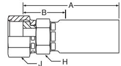
**WERKSTOFF** Stahl, verzinkt, transparent Cr(VI)-frei passiviert.
