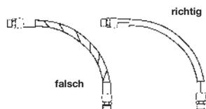
Der Schlauch wird geschwächt, wenn er verdreht eingebaut wird. Außerdem können Druckimpulse in verdrehtem Schlauch zur Ermüdung des Drahtes und zur Lockerung der Armaturenverbindung führen. Die Maschine sollte so ausgelegt werden, dass der Schlauch durch ihre Bewegungen eher gebogen als verdreht wird.
