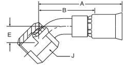
**WERKSTOFF** Stahl, verzinkt, transparent Cr(VI)-frei passiviert.
