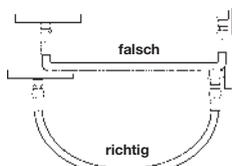
Der Schlauch sollte gerade und nicht seitwärts aus der Kupplung herausgeführt werden. Der Mindestbiegeradius darf nicht unterschritten werden, um ein Abknicken des Schlauchs und eine Behinderung des Durchflusses zu vermeiden.
