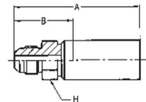
**WERKSTOFF** Stahl, verzinkt, transparent Cr(VI)-frei passiviert.
