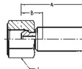
**WERKSTOFF** Stahl, verzinkt, transparent Cr(VI)-frei passiviert.
