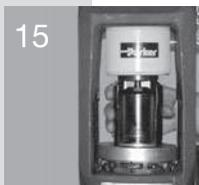
Press-Stempel auf dem Schulterbolzen ausrichten.
