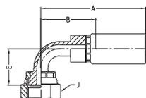
**WERKSTOFF** Stahl, verzinkt, transparent Cr(VI)-frei passiviert.
