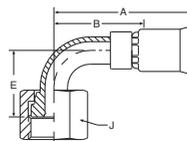
**WERKSTOFF** Stahl, verzinkt, transparent Cr(VI)-frei passiviert.
