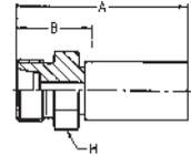
**WERKSTOFF** Stahl, verzinkt, transparent Cr(VI)-frei passiviert.
