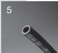
Beide Schlauchenden visuell auf Rechtwinkligkeit überprüfen. Eventuelle Grate an der Innenschicht mit einem scharfen Messer entfernen.
