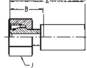
**WERKSTOFF** Stahl, verzinkt, transparent Cr(VI)-frei passiviert.
