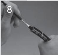
Die Innenseite des Schlauchendes mit einem SAE 20 Schmieröl schmieren.
