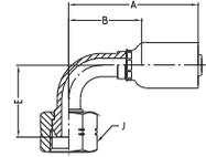
**WERKSTOFF** Stahl, verzinkt, transparent Cr(VI)-frei passiviert.
