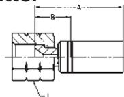
**WERKSTOFF** Stahl, verzinkt, transparent Cr(VI)-frei passiviert.
