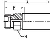
**WERKSTOFF** Stahl, verzinkt, transparent Cr(VI)-frei passiviert.
