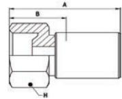
**WERKSTOFF** Nippel: Stahl, verzinkt, transparent Cr(VI)-frei passiviert.
