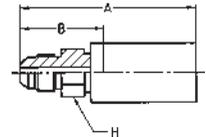
**WERKSTOFF** Stahl, verzinkt, transparent Cr(VI)-frei passiviert.
