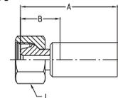
**WERKSTOFF** Stahl, verzinkt, transparent Cr(VI)-frei passiviert.
