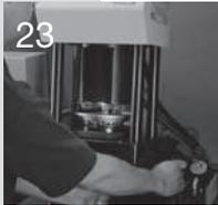
Ventilhebel nach hinten drücken, um Stempel zurückzuziehen und Pressbacken zu öffnen.
