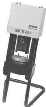
Die KarryKrimp® 2 ist tragbar, kompakt und robust und ist für das Verpressen von Schläuchen von DN 6 bis DN 32 geeignet. Das Modell 85C-061 besteht aus Schlauchpresse, zerlegbarem Ständer, Backenringen und einem Anschluss Schlauch mit Schnellkupplung. Geeignet für Parker-Schlauch mit Druckträger aus Textilfaser oder Stahldraht bis 4SP DN 32 und 4SH/100 R13 bis DN 25. Komplett mit Schlauchleitung und Schnellkupplung, 2 Backenringen und zerlegbarem Ständer.
