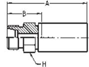
**WERKSTOFF** Stahl, verzinkt, transparent Cr(VI)-frei passiviert.
