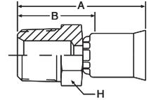
**WERKSTOFF** Stahl, verzinkt, transparent Cr(VI)-frei passiviert.
