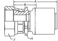
**WERKSTOFF** Stahl, verzinkt, transparent Cr(VI)-frei passiviert.
