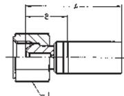
**WERKSTOFF** Stahl, verzinkt, transparent Cr(VI)-frei passiviert.
