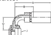
**WERKSTOFF** Stahl, verzinkt, transparent Cr(VI)-frei passiviert.
