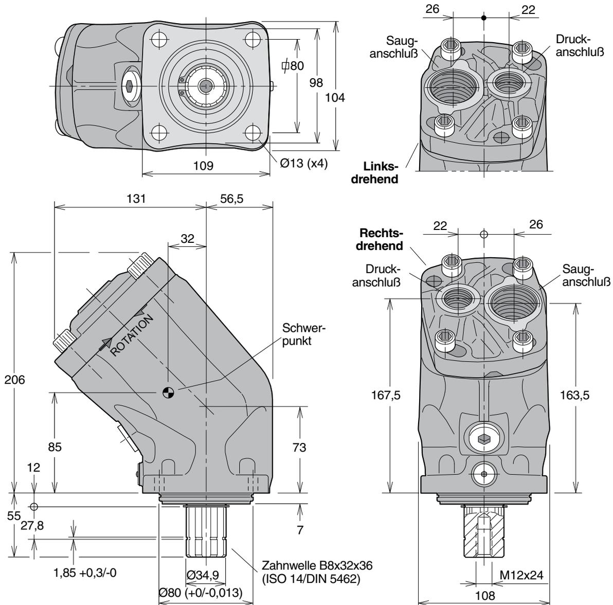
**Anschlüsse** (Anschlüsse mit BSP-Gewinde)
