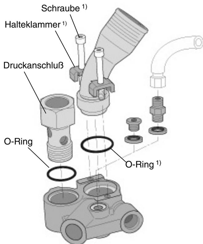
1) Montagesatz für Ansaugadapter auf Bypass-Ventil für F1, T1, F2 und F3 (Der Montagesatz besteht aus den mit „1“ gekennzeichneten Teilen in der Explosionszeichnung).
