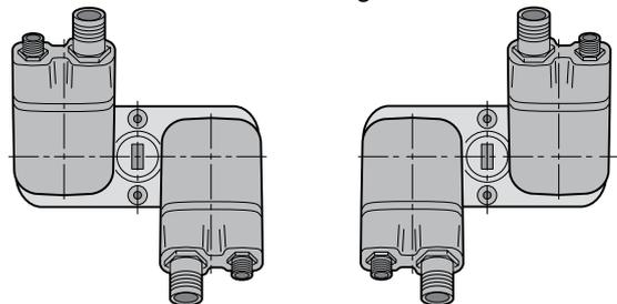
**HINWEIS:** Die Sauganschlüsse der Pumpen sollen immer der Mitte des Verteilergetriebes zugewandt sein (siehe Abb.), damit internen Getriebekräften entgegengewirkt wird.
