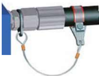
Sicherungsseile für Schlauch mit Einschraubverbindung
